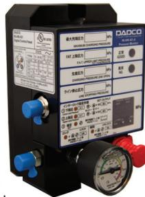
90.406.421. Le panneau de commande avec moniteur de pression est utilisé pour remplir et surveiller la pression des ressorts à gaz azote reliés depuis l'extérieur de la matrice. Le panneau est réglable pour afficher la pression en bar, psi ou MPa et comprend un capteur de pression numérique avec sortie programmable pour signaler si la pression chute en dessous d'un niveau prédéfini. Ce panneau est conforme à la norme Toyota numéro D-PACPS-B.
